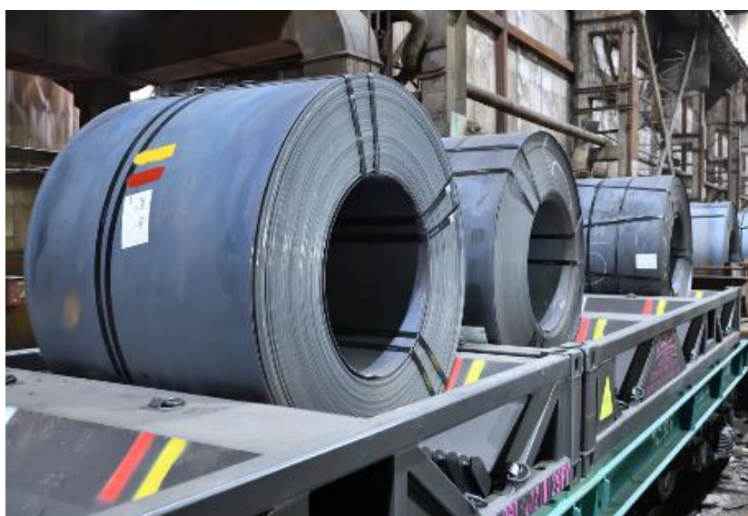
Рисунок 4 - Текущий способ хранения и отгрузки рулонной продукции в ЛПЦ-1
