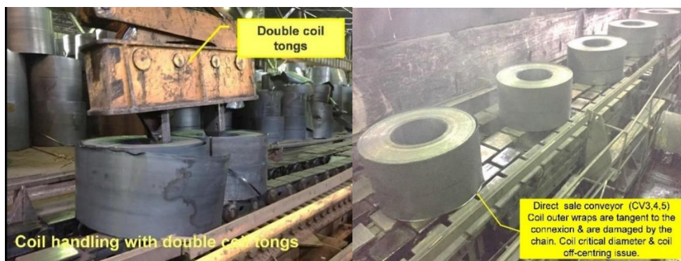
Рисунок 1 - Пример работы вертикальной оси транспортировки рулонов
