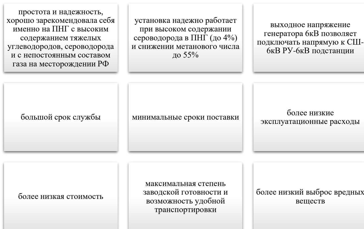
Рисунок 3 – Преимущества технических, экономических характеристик электростанции ГТУ типа «OP16» производства «OPRA Turbines» (Нидерланды)
